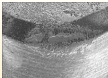
Właściwe stosowanie KB1340 — tworzenie warstwy ochronnej, trwałość narzędzia powinna przekraczać 70 km posuwu.
